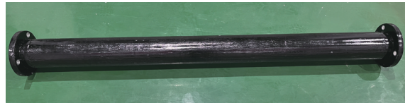
图8 制备完成的全碳纤维复合材料传动轴
